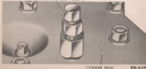
Fig. 13—Removing Cylinder Head Stud
